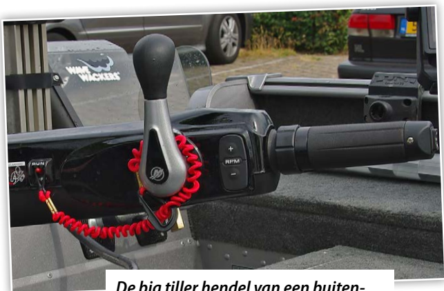
De big tiller hendel van een buitenboordmotor van Mercury.
