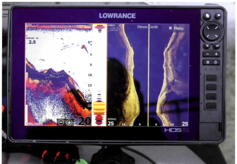
Zowel de Structure Scan (dat harde structuren duidelijk aangeeft) als ook de dubbele bodemecho laten zien dat de bodem hard is.
