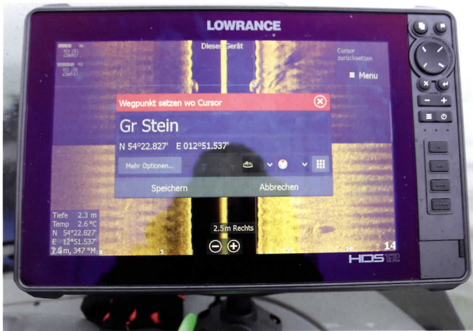
Met Structure Scan een steen gevonden, op het beeldscherm getikt, daarmee is de hotspot al vastgelegd op de waterkaart.
